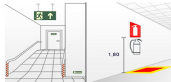
Figura 4 - Aplicação de Placas de Sinalização de Emergência
