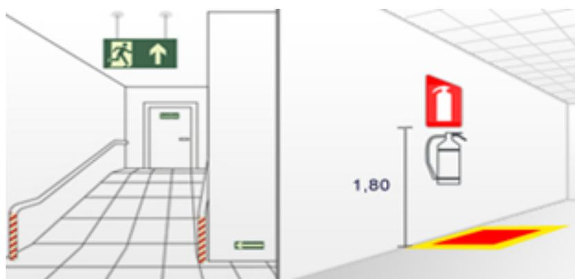
Figura 4 - Aplicação de Placas de Sinalização de Emergência
