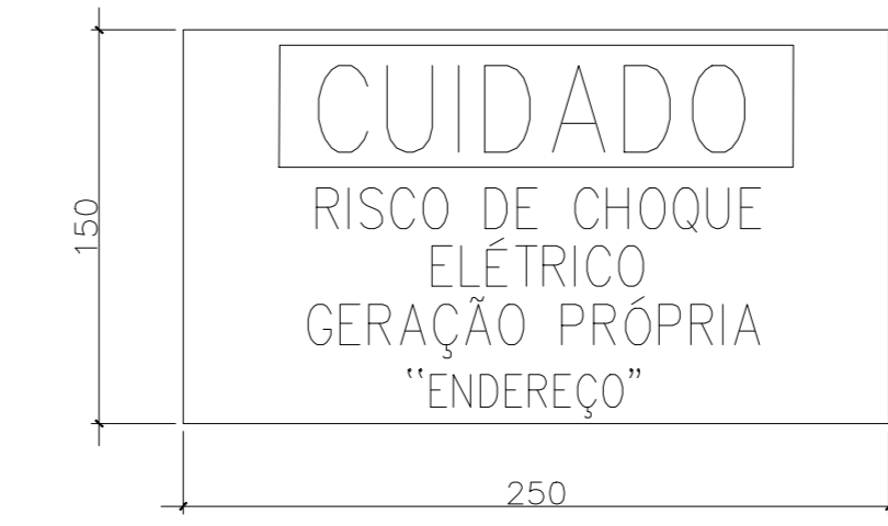
DETALHE DA PLACA DE ADVERTÊNCIA DE SEGURANÇA
