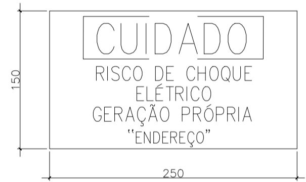
DETALHE DA PLACA DE ADVERTÊNCIA DE SEGURANÇA
